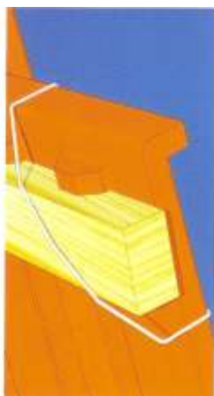
Rys 6. Klamra do dachówek Rupp uniwersalna
