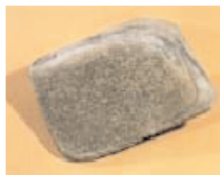
Dachówka cementowa z 1850 r
